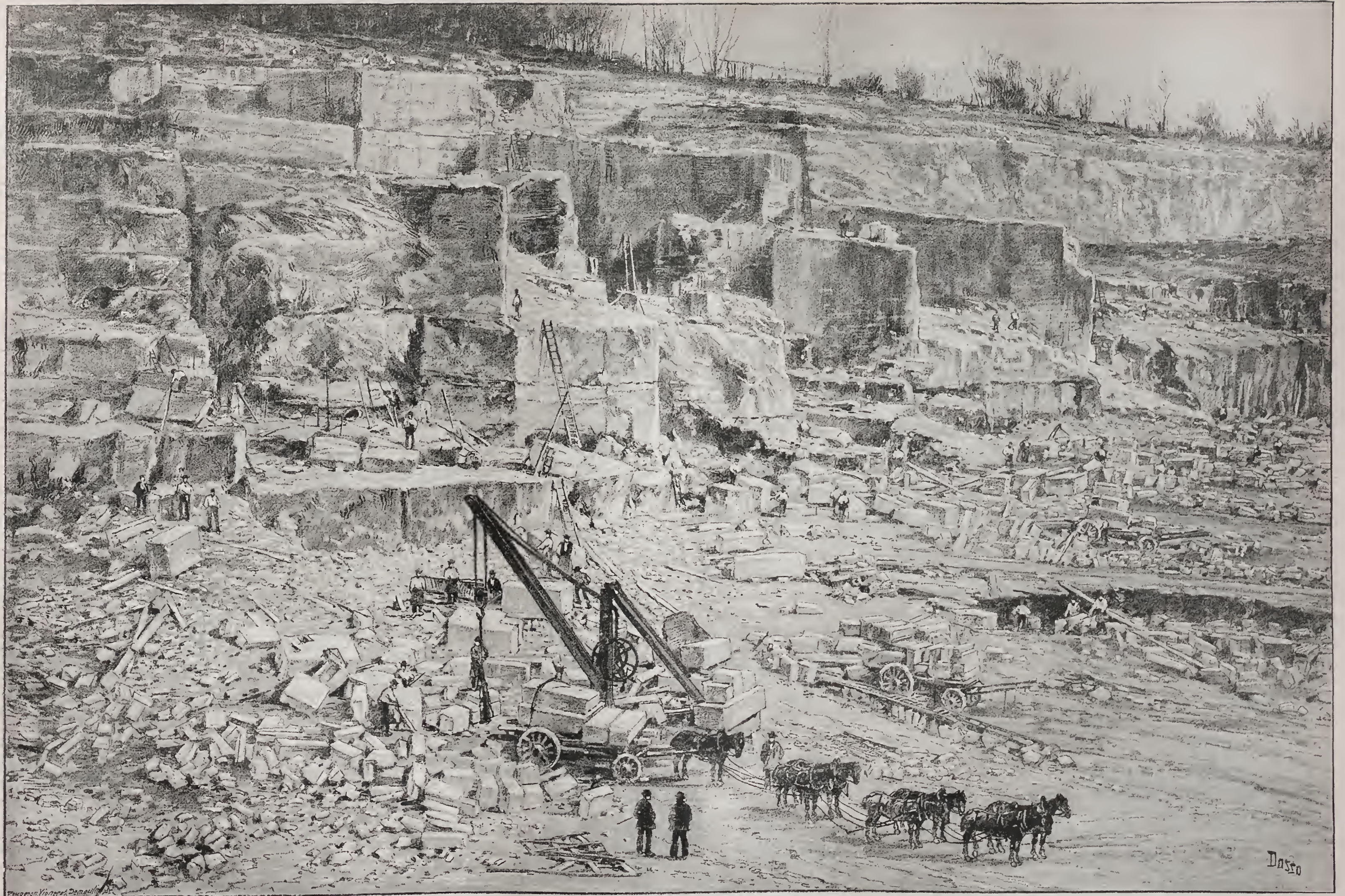
LES MATÉRIAUX DE L'EXPOSITION. — Extraction de la pierre de taille, dans les carrières d'Euville.
